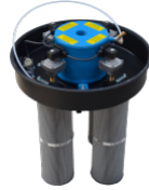
SP Décolmatage cartouches par injection air réseau air comprimé Filtre antistatique classe M (EN 60335-2-694, cartouches polyester antistatiques, 12 m 2 Surface filtrante
