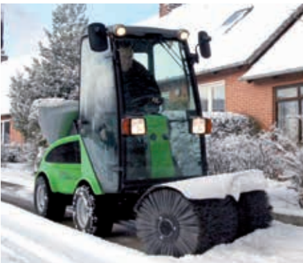
Balayage aspiratrice avec 3ème et 4ème balai
