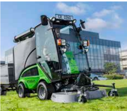
Tondeuse rotative/mulching 1200 avec collecteur d'herbe
