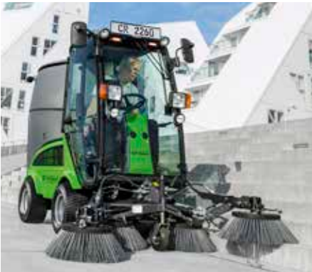
Balayage aspiratrice avec 3ème et 4ème balai
