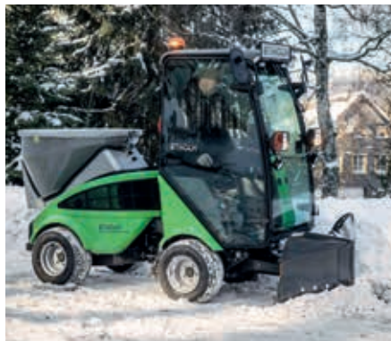
Lame chasse-neige en V et épardeur de sel et de sable
