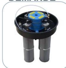
L'option SP est le système le meilleur pour le décolmatage automatique du filtre, qui utilise l'air comprimé à 6 bars pour nettoyer les cartouches. Grâce à sa grande surface et à son efficacité, il est possible de travailler aussi avec des quantités importantes de poussières fines. Les filtres sont aluminisés et antistatiques, avec une filtration en classe M-BIA (EN 60335-2-69). Le décolmatage fonctionne pendant que l'aspirateur est en marche.
