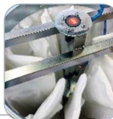
Le système PSC est un secoueur du filtre automatique. A l'intérieur de la chambre filtrante il y a un piston pneumatique qui secoue le filtre chaque fois que l'opérateur presse sur la touche d'activation. En option il est possible d'installer un PLC pour avoir un cycle complètement automatisé.
