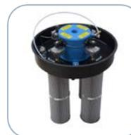
L'option SP est le système le meilleur pour le décolmatage automatique du filtre, qui utilise l'air comprimé à 6 bars pour nettoyer les cartouches. Grâce à sa grande surface et à sa efficacité, il est possible de travailler aussi avec des quantités importantes de poussières fines. Les filtres sont aluminisés et antistatiques, avec une filtration en classe M-BIA (EN 60335-2-69). Le décolmatage fonctionne pendant que l'aspirateur est en marche.
