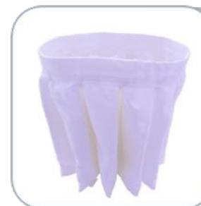
La filtration est assurée par un filtre en polyester en classe M. De cette façon l'air peut passer à travers le filtre même s'il est sal. Il est certifié en classe M (BIA | EN 60335-2-69). Il arrête toutes particules jusqu'au 1 micron, en préservant les moteurs et la santé de l'opérateur.
