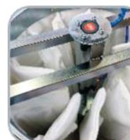
Le système PSC est un secoueur du filtre automatique. A l'intérieure de la chambre filtrante il y a un piston pneumatique qui secoue le filtre chaque fois que l'opérateur presse sur la touche d'activation. En option il est possible d'installer un PLC pour avoir un cycle complètement automatisé.
