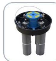
L'option SP est le système le meilleur pour le décolmatage automatique du filtre, qui utilise l'air comprimé à 6 bars pour nettoyer les cartouches. Grâce à sa grande surface et à sa efficacité, il est possible de travailler aussi avec des quantités importantes de poussières fines. Les filtres sont aluminisés et antistatiques, avec une filtration en classe M-BIA (EN 60335-2-69). Le décolmatage fonctionne pendant que l'aspirateur est en marche.
