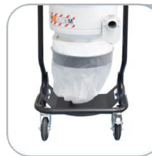
Le matériel récolté est recueilli dans un robuste conteneur en plastique nommé Longopac®. Le sac est long 20 mètres et il est enroulé autour de la partie inférieure de la chambre du filtre. Il est possible d'adapter le sac à chaque exigence. L'opérateur, une fois le sac sera rempli, pourra le fermer au dessus du matériel collecté qui tombe automatiquement à l'intérieur du sac, le fermer e couper la partie pleine du sac pour la jeter en sécurité, sans contact entre le matériel et l'utilisateur.
