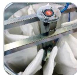
Le système PSC est un secoueur du filtre automatique. A l'intérieure de la chambre filtrante il y a un piston pneumatique qui secoue le filtre chaque fois que l'opérateur presse sur la touche d'activation. En option il est possible d'installer un PLC pour avoir un cycle complètement automatisé
