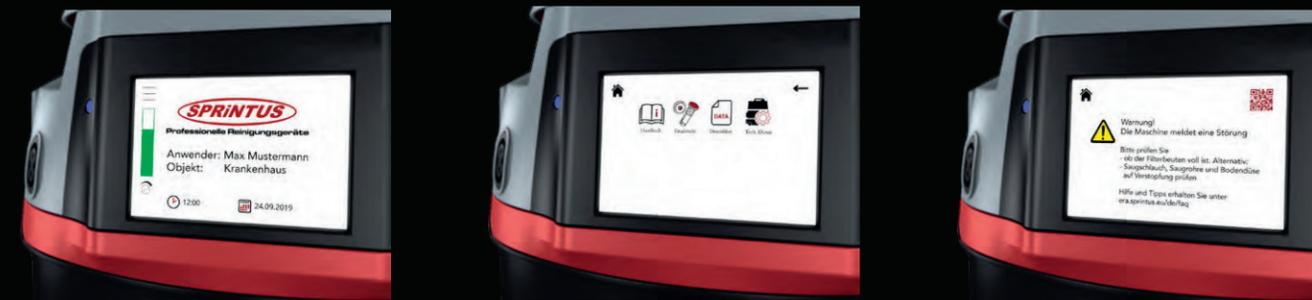
L'écran tactile interactif affiche les temps de fonctionnement, les défauts, la maintenance, la date et l'heure. Le réglage de l'écran de démarrage est personnalisable. Par exemple, les données sur l'appareil et l'utilisateur peuvent être importées et affichées en permanence.
