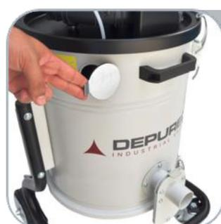
L'aspirateur est équipé avec un nouveau système de décolmatage qui s'appelle JetClean® étudié par Depureco. Grâce à la différence de pression entre l'intérieur et l'extérieur de l'aspirateur, le système produit un flux d'air dans la cartouche, en détachant la poussière de la surface du filtre. C'est une méthode rapide et efficace pour maintenir le filtre propre pendant les opérations, sans arrêter les moteurs.
