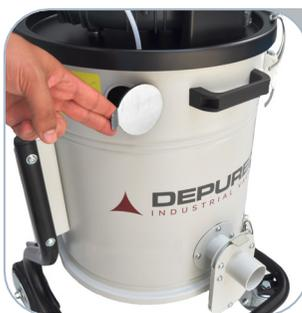
L'aspirateur est équipé avec un nouveau système de décolmatage qui s'appelle JetClean® étudié par Depureco. Grâce à la différence de pression entre l'intérieur et l'extérieur de l'aspirateur, le système produit un flux d'air dans la cartouche, en détachant la poussière de la surface du filtre. C'est une méthode rapide et efficace pour maintenir le filtre propre pendant les opérations, sans arrêter les moteurs.
