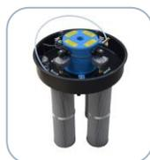
L'option SP comprend un système de nettoyage des filtres à cartouche avec un flux à contre-courant d'air à 6 bar. Ce système est extrêmement efficace même pour les poussières les plus fines. Chaque filtre est propre grâce à des électrovannes indépendantes qui garantissent le nettoyage sans arrêter l'aspirateur.
