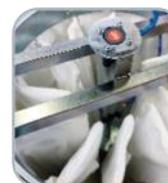
Le système PSC est un secoueur du filtre automatique. A l'intérieure de la chambre filtrante il y a un piston pneumatique qui secoue le filtre chaque fois que l'opérateur presse sur la touche d'activation. En option il est possible d'installer un PLC pour avoir un cycle complètement automatisé
