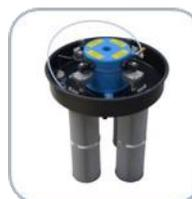
L'option SP est le système le meilleur pour le décolmatage automatique du filtre, qui utilise de l'air comprimé à 6 bars pour nettoyer les cartouches. Grâce à sa grande surface et à son efficacité, il est possible de travailler aussi avec des quantités importantes de poussières fines. Les filtres sont aluminisés et antistatiques, avec une filtration en classe M-BIA (EN 60335-2-69). Le décolmatage fonctionne pendant que l'aspirateur est en marche.
