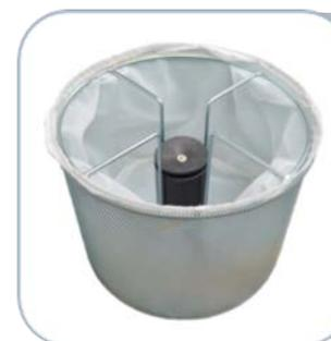
Le liquide aspiré peut être filtré à travers d'un filtre en nylon avec une efficacité de 150 micron. Grâce à ce système, il est possible de séparer aussi des petits copeaux d'huile et recycler les lubrifiants. Le filtre peut être lavé et réutilisé facilement.
