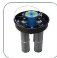
L'option SP est le système le meilleur pour le décolmatage automatique du filtre, qui utilise l'air comprimé à 6 bars pour nettoyer les cartouches. Grâce à sa grande surface et à son efficacité, il est possible de travailler aussi avec des quantités importantes de poussières fines. Les filtres sont aluminisés et antistatiques, avec une filtration en classe M-BIA (EN 60335-2-69). Le décolmatage fonctionne pendant que l'aspirateur est en marche.
