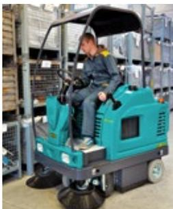
Pour un maximum de confort et de sécurité lors de la conduite, XTREMA est disponible avec de nombreux accessoires: Eclairage complet / Signal sonore de marche arrière / Toit de protection / Pare-brise en polycarbonate / Clignotants (standard dans les pays CE) / filtre à poche classe M.
