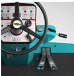
La XTREMA possède un puissant système de traction, à vitesse variable, jusqu'à 9km/h, contrôlé à l'aide d'une double pédale (marche avant et marche arrière).
