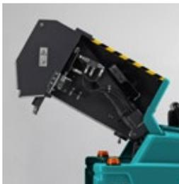
Le conteneur à déchets, à décharge multiniveaux est doté d'un hayon d'ouverture/fermeture à contrôle hydraulique. Il est situé sur la partie postérieure, a une capacité de 150 litres et peut être soulevé hydrauliquement du sol jusqu'à une hauteur de 1350mm.
