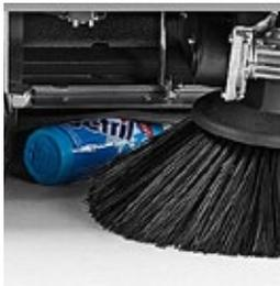
Le dispositif « lève-flap » s'active directement à partir du poste de conduite. Il permet à la brosse centrale de récolter aussi les déchets les plus volumineux et encombrants.
