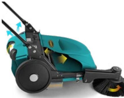
La roue latérale de la balayeuse, en plus d'activer la brosse centrale pour la récolte des déchets, fait tourner rapidement un arbre de transmission relié à un ventilateur qui, grâce au rapport des diamètres (roue- arbre de transmission), aspire toute la poussière et la guide vers le filtre. Le système permet d'intégrer à une balayeuse manuelle un système efficace d'aspiration/filtration qui ne nécessite pas de motorisation, afin de garantir simplicité, économie et écologie.
