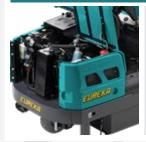
Tous les organes mécaniques internes sont facilement accessibles pour les opérations d'entretien puisque les panneaux postérieurs peuvent s'ouvrir complètement. Les batteries (version EB EVOLUTION) peuvent être remplacées facilement et rapidement.
