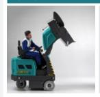
Le caisson à déchets est positionné à l'avant de la machine et peut être soule-vé hydrauliquement jusqu'à une hauteur de 1.565 mm. Le caisson est flottant et s'ajuste automatiquement, ce qui permet une récolte plus simple des déchets plus volumineux.
