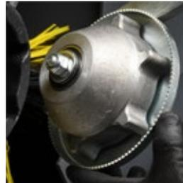
Pour éviter que l'enchevêtrement involontaire des ficelles, bandes de plastique ou en fer, réduise l'efficacité des brosses et la durée de vie des roulements.
