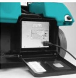
Deux batteries de 12V garantissent à la E46 une autonomie de travail de 2h10 à chaque cycle de charge. Le charge batterie à bord est protégé par une structure en acier facile d'accès.
